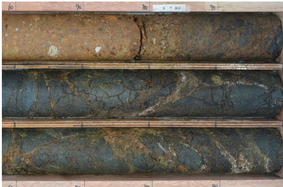
写真 10-12 洗浄してマッドケーキを取り除いた状態
