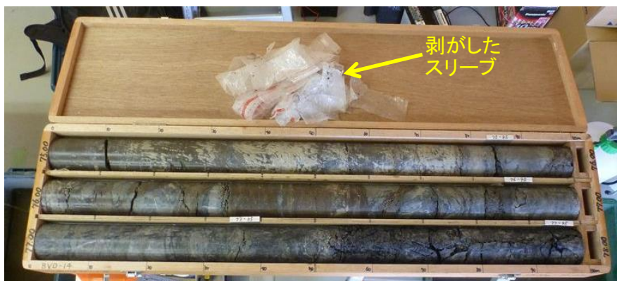
写真10-7 スリーブを剥がした状態
