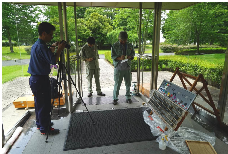
写真 8-1 ボーリングコア写真撮影方法（コアスタンドタイプ）の例
